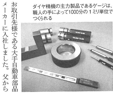
ダイヤ精機の主力製品であるゲージは、職人の手によって1000分の1ミリ単位でつくられる
